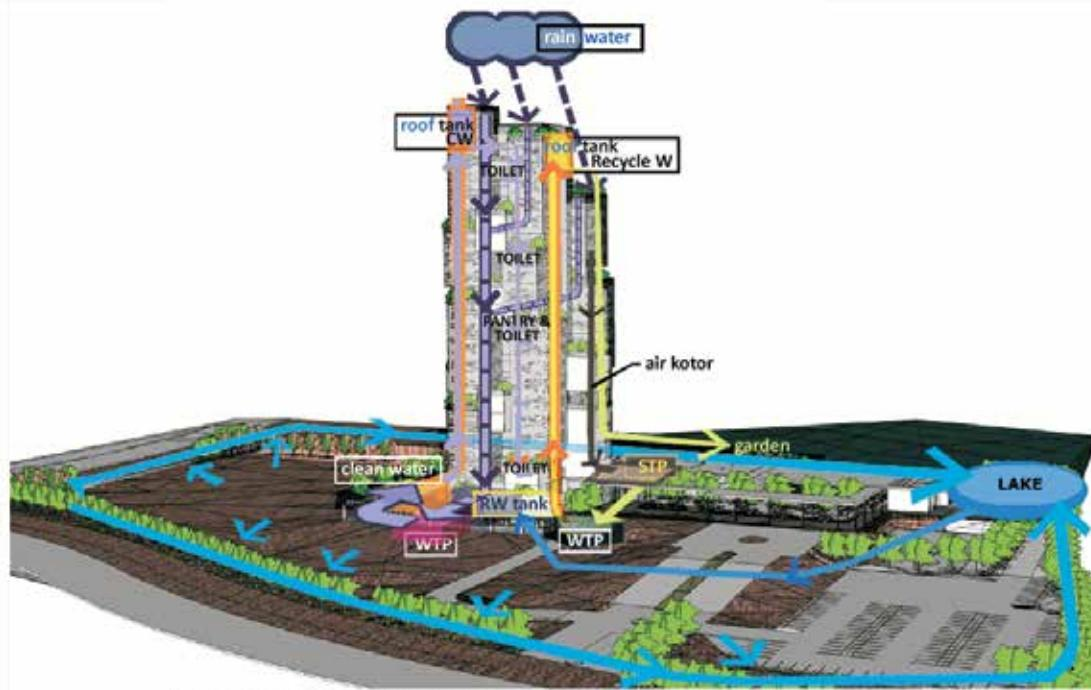
Diagram Pemanfaatan Air Hujan, Air Danau dan Sistem Recycle Air Kotor
