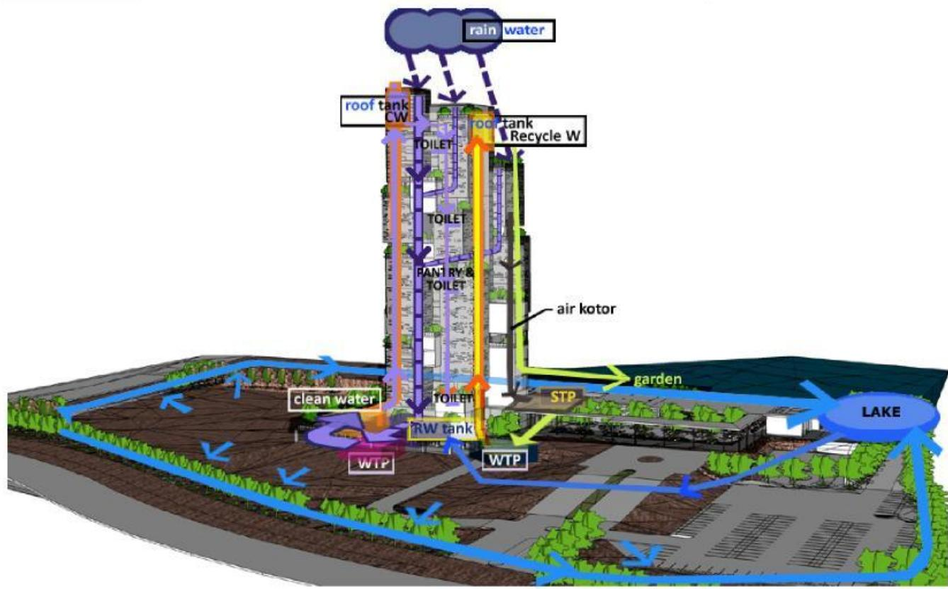
Diagram Pemanfaatan Air Hujan, Air Danau dan Sistem Recycle Air Kotor
